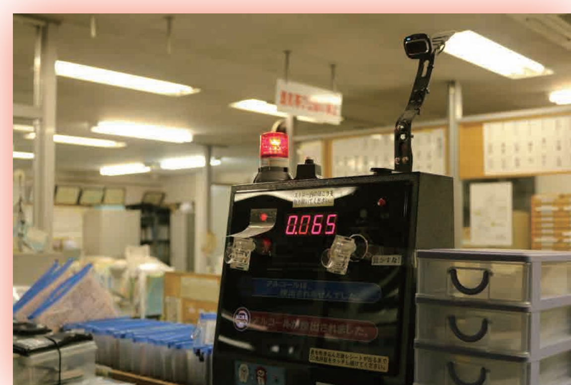
アルコール検知器 検知すると赤色のランプが回転します
