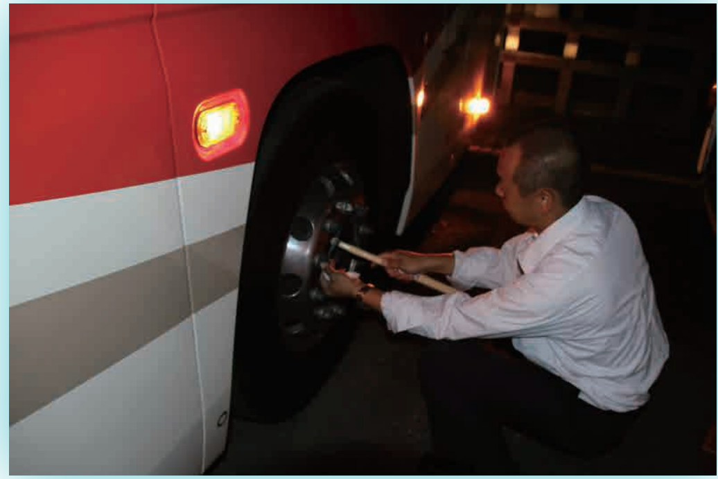
ハンマーを使って点検します。異常がないかを確認していきます。
