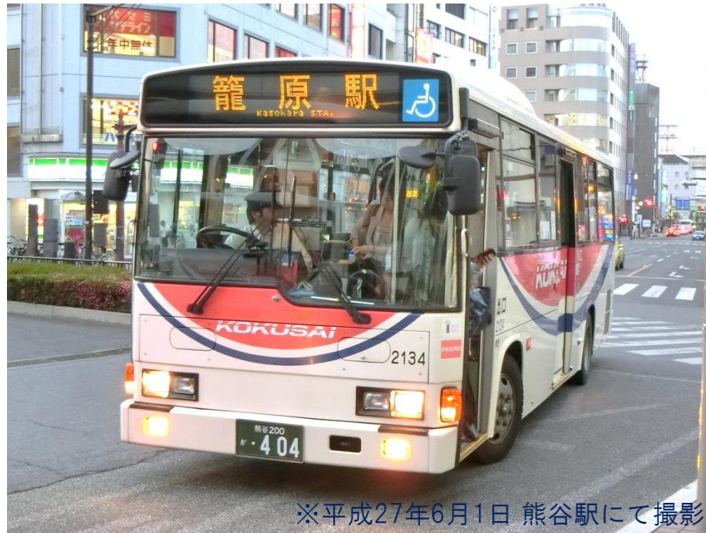
2134号車 2003(H15)年式 日野レインボーRJ (9m,ワンステップ)
